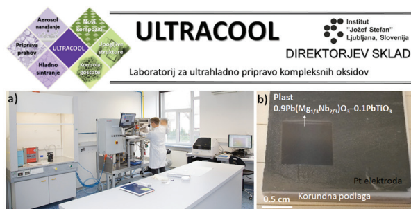
Slika 4: a) Fotografija laboratorija za ultrahladno pripravo kompleksnih oksidov ULTRACOOOL (direktorjev sklad 2017). Na sliki je vidna naprava za nanašanje trdnih delcev v curku aerosola. Pri tej tehniki izstreljeni delci prahu trčijo z veliko hitrostjo s podlago, kar povzroči nastanek goste plasti na podlagi že pri sobni temperaturi. b) Fotografija debele plasti, pripravljene pri sobni temperaturi v laboratoriju ULTRACOOOL.
